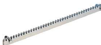
CM43012 A233.11002.00 Cremallera M4 zincada, 30x12x1000 mm.
