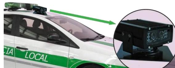
Scanner Móvil para usos Policiales. Instalado en un vehículo permite realizar lecturas móviles y de control.
